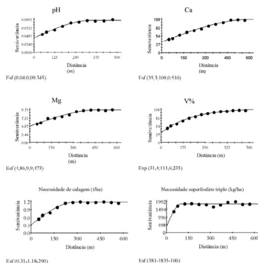
Figura 1: Semivariogramas das variáveis pH, cálcio ( $\text{mmol}_c\text{dm}^{-3}$ ), magnésio ( $\text{mmol}_c\text{dm}^{-3}$ ) e saturação por bases (V%) na profundidade de 0,0-0,2 m e necessidade de calagem e superfosfato triplo. Esf e Exp ( $C_0;C_0 + C_1;a$ ) é o modelo esférico e exponencial ajustado,  $C_o$  = efeito pepita;  $C_0+C_1$  = patamar;  $a$  = alcance.
