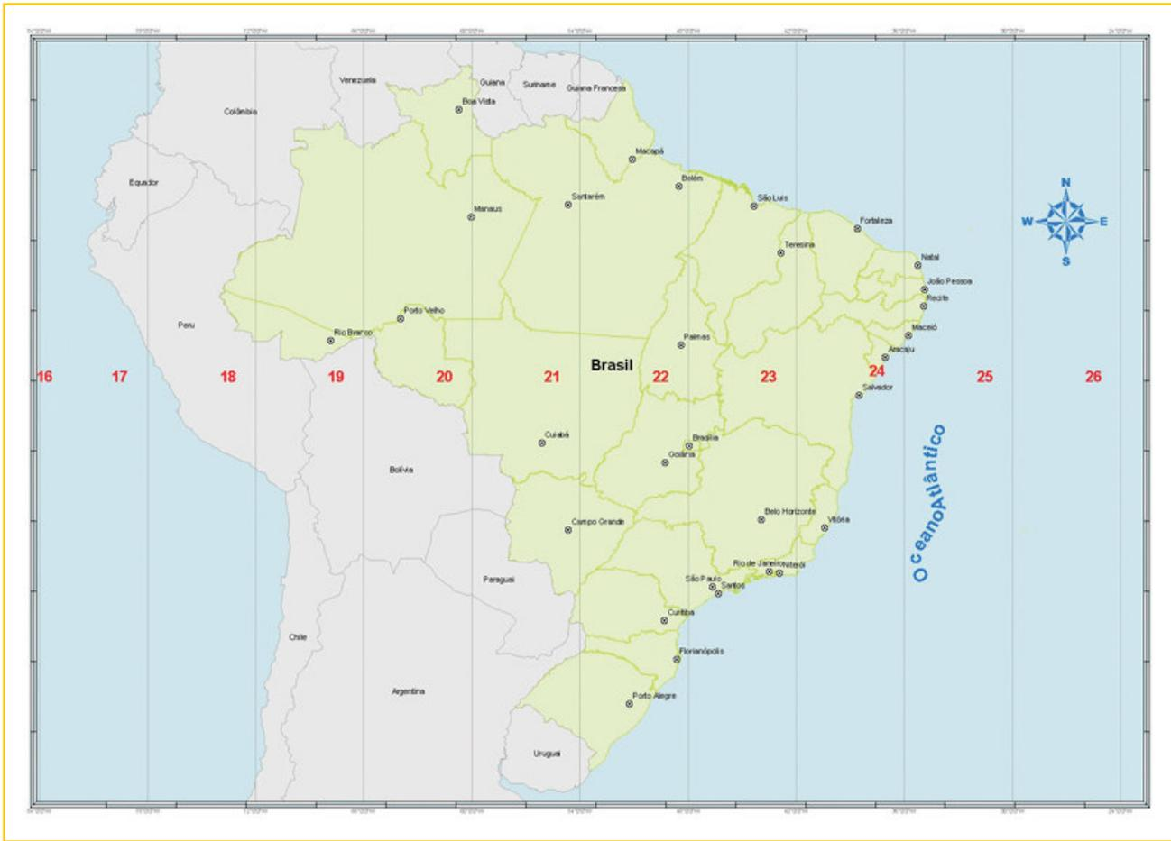
FIGURA 2.14 - Esquema do fuso UTM.
